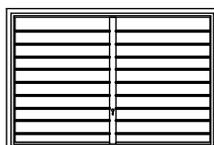
Stahl, waagrecht gesickt, verzinkt, pulverbeschichtet grundiert
